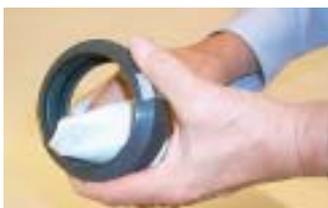
**Étape 5** - On lubrifie le joint en caoutchouc Tuf-Lok avec de l'eau savonneuse pour faciliter le montage.
