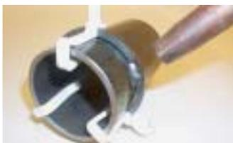
**Étape 3** - On fixe chaque anneau de maintien par des points de soudure entre les positionneurs d'anneaux.
