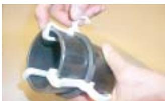
**Étape 2** - On met en place les anneaux métalliques de maintien Tuf-Lok avec les positionneurs d'anneaux en nylon fournis, ce qui assure une position correcte pour le soudage.
