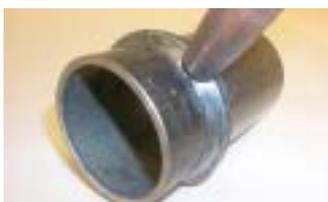
**Étape 4** - On retire les positionneurs d'anneaux puis on soude chaque anneau de maintien d'un trait continu, uniquement du côté de l'extrémité du tube. Il n'est pas nécessaire que la soudure soit étanche.
